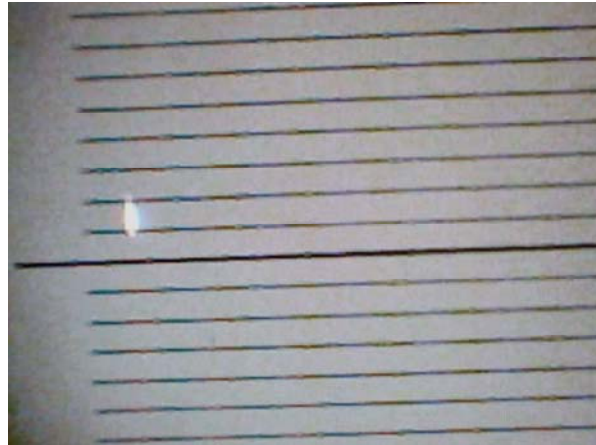
Fig. 3.4 Esempio di come si vede sul computer l'immagine di una gocciolina e della scala graduata.
